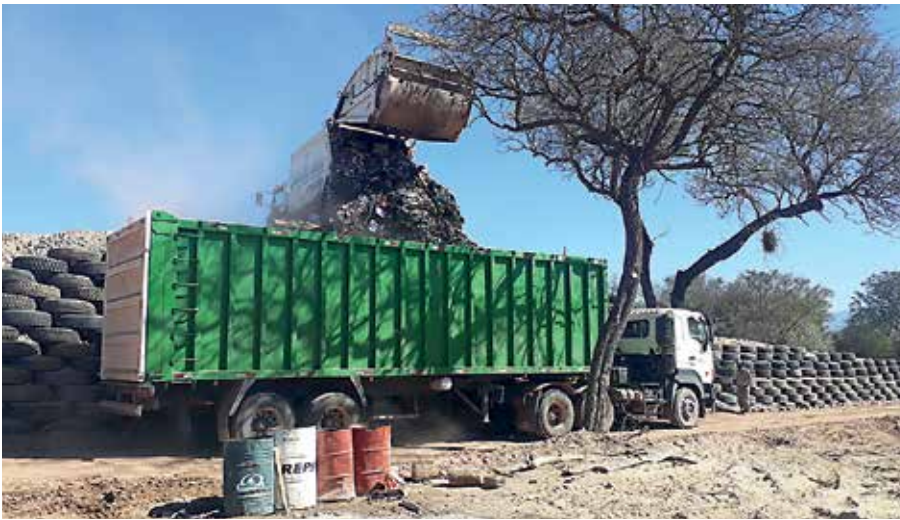
Estación de Transferencia de Villa Montes, sitio donde se despositan los residuos de los vehículos recolectores a vehículos de transferencia que van al sitio de disposición final.
